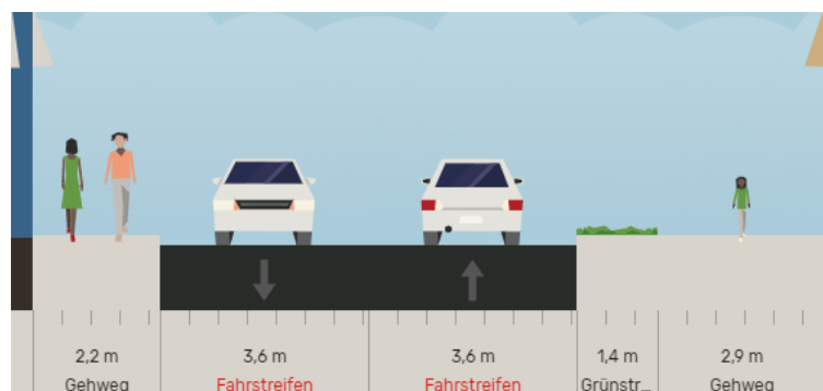
Abbildung 12: Querschnitt im Bestand i.H.v. Hausnummer 34, erstellt mit Streetmix
